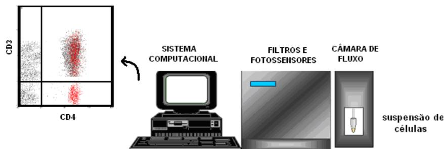
Figura 2.1. Citômetro de fluxo padrão. Câmara de fluxo, para onde a suspensão é aspirada; sistema de espelhos e foto-sensores para direcionamento e captação de luz, sistema computacional para a conversão em dados digitais e análise.
