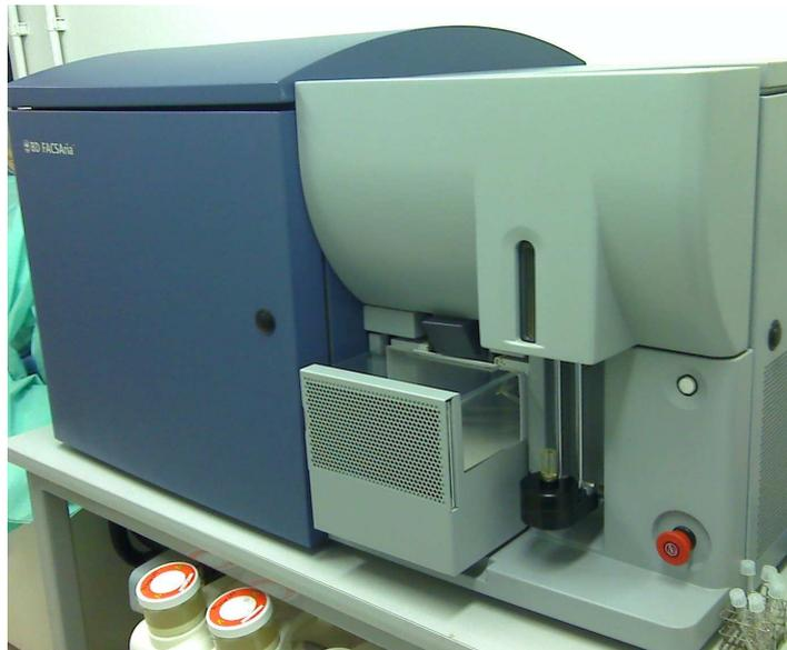
**Figura 2.4.**FACS Aria Cell Sorter. 2 lasers 11cores foto cortesia: Ferraz, R.
