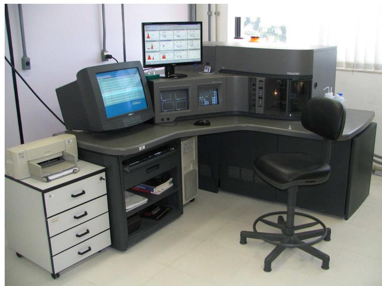
Figura 2.7. EPICS Altra Cell Sorter – Beckman Coulter - 1 laser, 4 cores – foto cortesia: Bertho, A.L.
