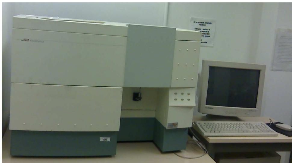
**Figura 2.5.** FACS Calibur Bench-top Analyzer – BD. 2 lasers, 4 cores. Foto cortesia: Ferraz, R.
