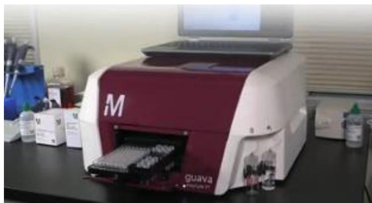
**Figura 2.30.** Guava® easyCyte (Merck-Millipore). Capacidade para até 5 lasers.
