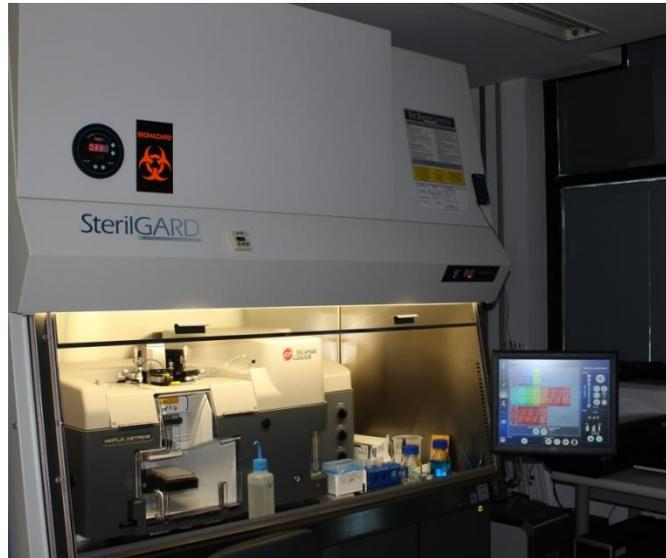
**Figura 2.20.** MoFlo Astrios *Cell Sorter* (Beckman Coulter). 3 *lasers*, 11 cores, *sorting* em 6 vias; *Software*: Summit 6.1. Plataforma de Citometria de Fluxo, Núcleo de Purificação Celular (*Sorting*), Instituto Oswaldo Cruz, FIOCRUZ. Foto-cortesia: Alvaro Luiz Bertho.
