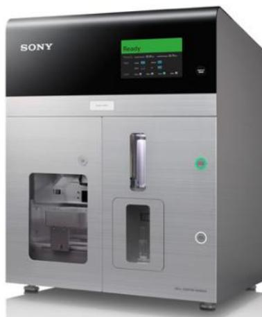
**Figura 2.29.** SH800Z *Cell Sorter* (Sony Biotechnology). Capacidade para 4 lasers.
