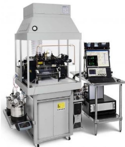
**Figura 2.27.** Influx *Cell Sorter* (BD). 3 *lasers*, 11 *cores*, *sorting em 6 vias*; *Software*: BD FACS.
