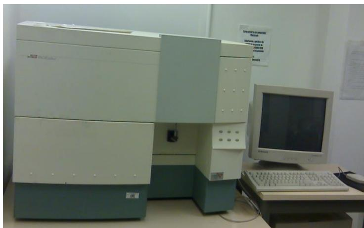
**Figura 2.17.** FACS Calibur Analyzer (BD). 2 lasers, 4 cores. Software: Cell Quest. Plataforma de Citometria de Fluxo, Núcleo de Análise Celular, Instituto Oswaldo Cruz, FIOCRUZ. Foto-cortesia: Raquel Ferraz.
