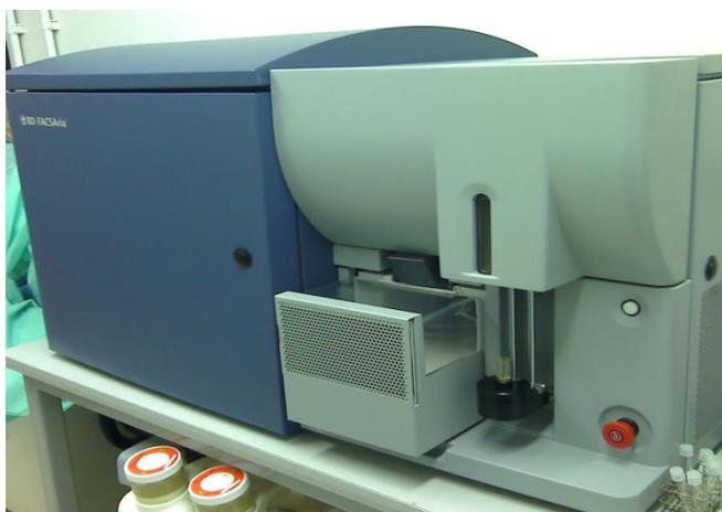
**Figura 2.22.** FACS Aria II *Cell sorter* (BD). 2 lasers 11 cores; Software: Diva. Plataforma PDTIS, FIOCRUZ. Foto-cortesia: Raquel Ferraz.
