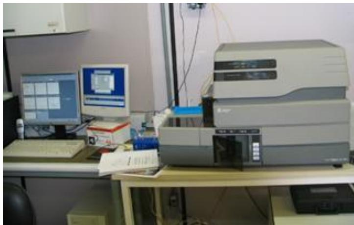
**Figura 2.19.** EPICS XL-MCL Analyzer (Beckman Coulter). 1 *laser*, 4 cores. *Software*: Expo 32. Plataforma de Citometria de Fluxo, Núcleo de Purificação Celular (*Cell Sorting*), Instituto Oswaldo Cruz, FIOCRUZ. Foto-cortesia: Alvaro Luiz Bertho.
