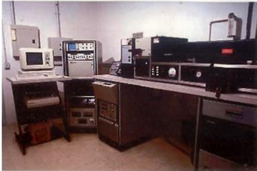
**Figura 2.16** EPICS 751 *Cell Sorter* da então Coulter Electronics, Inc. Primeiro citômetro de fluxo instalado no Brasil, em 1988 – 2 lasers, 4 cores, *sorting* em duas vias. Dept. de Protozoologia, IOC, FIOCRUZ, de 1989 a 1999. Foto-cortesia: Alvaro Luiz Bertho.
