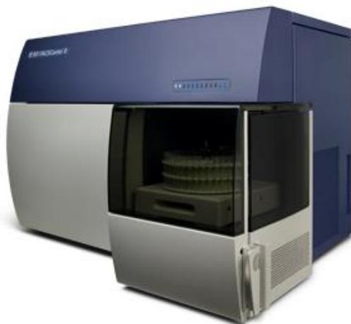
**Figura 2.25.** FACS Canto *Analyzer* (BD). 2 lasers, 8 cores. Software. DIVA. Instituto Oswaldo Cruz, FIOCRUZ. Foto-cortesia: BD.
