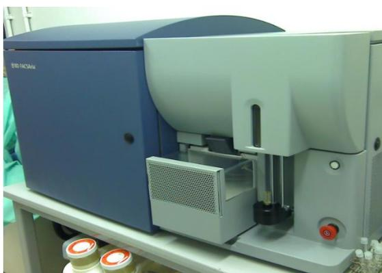
**Figura 2.28** - FACS Aria II Cell sorter (BD). 2 LASERs 11cores; Software: Diva. Plataforma PDTIS, FIOCRUZ.
