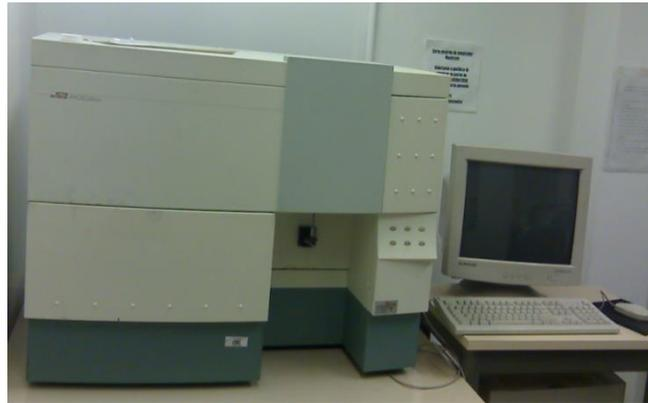
**Figura 2.23** - FACS Calibur Analyzer (BD). 2 LASERs, 4 cores. Software: Cell Quest. Plataforma de Citometria de Fluxo, Núcleo de Análise Celular, Instituto Oswaldo Cruz, FIOCRUZ.
