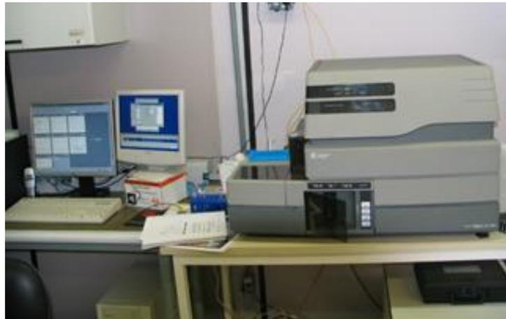
**Figura 2.25** - EPICS XL-MCL Analyzer (Beckman Coulter). 1 LASER, 4 cores. Software: Expo 32. Plataforma de Citometria de Fluxo, Núcleo de Purificação Celular (*Cell Sorting*), Instituto Oswaldo Cruz, FIOCRUZ.
