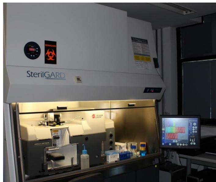
**Figura 2.26** - MoFlo Astrios Cell Sorter (Beckman Coulter). 3 LASERs, 11 cores, *sorting* em 6 vias; Software: Summit 6.1. Plataforma de Citometria de Fluxo, Núcleo de Purificação Celular (*Sorting*), Instituto Oswaldo Cruz, FIOCRUZ.
