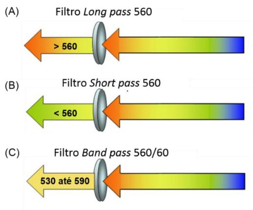
**Figura 2.6** - Ilustração de um (A) filtro *long pass* 560, (B) filtro *short pass* 560 e (C) filtro *band pass* 560
