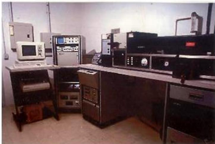
**Figura 6.1** - EPICS 751 *Cell Sorter* da então Coulter Electronics, Inc. Primeiro citômetro de fluxo instalado no Brasil, em 1988 – 2 *LASERs*, 4 cores, *sorting* em duas vias. Dept. de Protozoologia, IOC, FIOCRUZ, de 1989 a 1999. Foto-cortesia: Alvaro Luiz Bertho.
