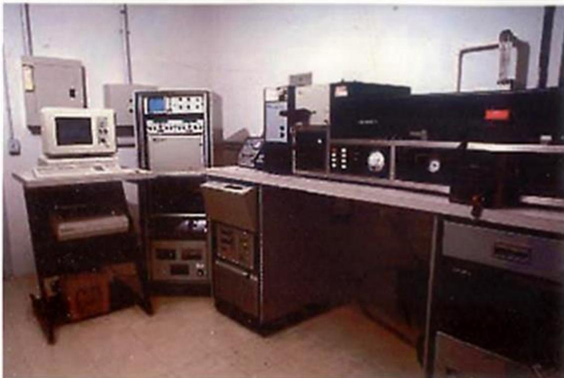
**Figura 1.1** - EPICS 751 *Cell Sorter* da então Coulter Electronics, Inc. Primeiro citômetro de fluxo instalado no Brasil, em 1988 – 2 *LASERs*, 4 cores, *sorting* em duas vias. Dept. de Protozoologia, IOC, FIOCRUZ, de 1989 a 1999. Foto-cortesia: Alvaro Luiz Bertho.
