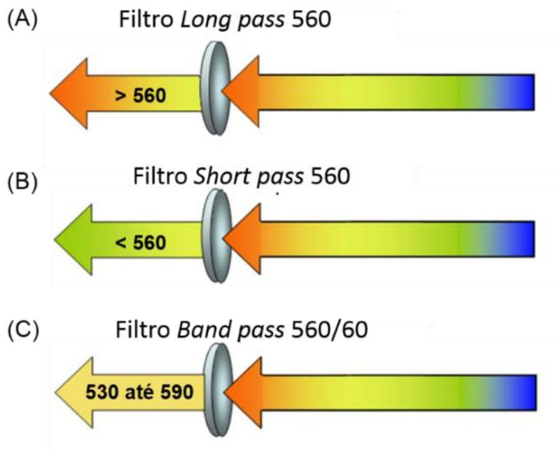
**Figura 3.8** - Ilustração de um (A) filtro *Long Pass* 560, (B) filtro *Short Pass* 560 e (C) filtro *Band Pass* 560
