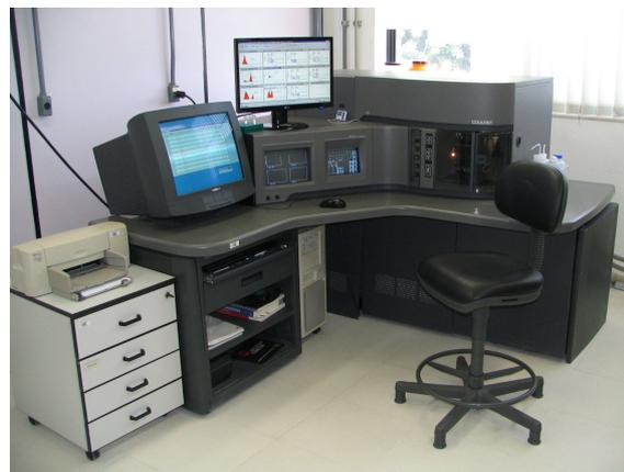
**Figura 2.20.** EPICS Altra Cell Sorter – Beckman Coulter - 1 laser, 4 cores; Software: Expo32. Plataforma de citometria de Fluxo, Núcleo de Análise e Sorting, IOC. Foto-cortesia: Bertho, A.L.
