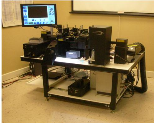
**Figura 2.24.** MoFlo XDP *Cell Sorter*. Beckman Coulter - 3 *lasers*, 11 cores; *Software*: Kaluza - foto cortesia: Bertho, A.L.
