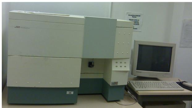
**Figura 2.18.** FACSCalibur Bench-top Analyzer – BD. 2 lasers, 4 cores. Software: Cell Quest. Plataforma de Citometria de Fluxo, Núcleo de Análise, IOC. Foto-cortesia: Ferraz, R.
