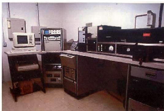
**Figura 2.17:** EPICS 751 *Cell Sorter* da então Coulter Electronics, Inc. Primeiro citômetro de fluxo instalado no Brasil, em 1988 – 2 *lasers*, 4 cores, *sorting*. Foto-cortesia: Bertho A.L.
