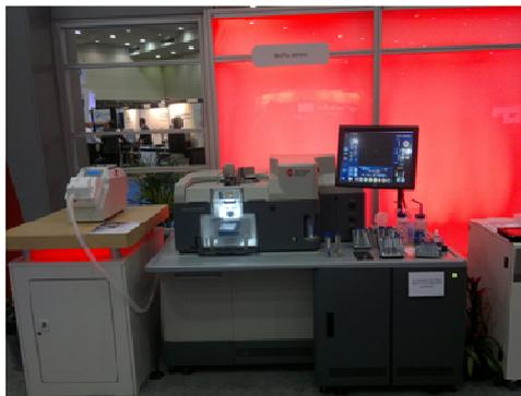
**Figura 2.25:** MoFlo Astrios *Cell sorter*. Beckman Coulter - 3 *lasers*, 11 cores, *sorting* em 6 vias; *Software*: Kaluza. Foto-cortesia: Bertho, A.L.
