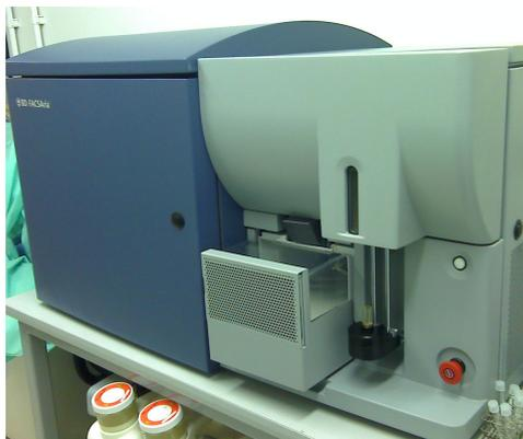
**Figura 2.22.** FACS Aria *Cell sorter* - BD. 2 lasers 11 cores; Software: Diva. Foto-cortesia: Ferraz, R.
