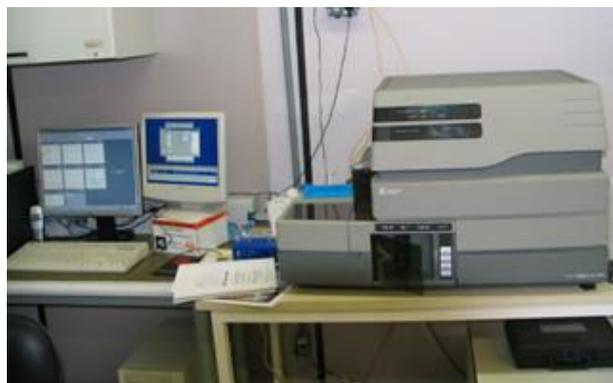
**Figura 2.21.** EPICS XL-MCL Bench-top Analyzer – Beckman Coulter - 1 laser, 4 cores; Software: Expo 32. Plataforma de citometria de Fluxo, Núcleo de Análise e Sorting (IOC). Foto-cortesia: Bertho, A.L.
